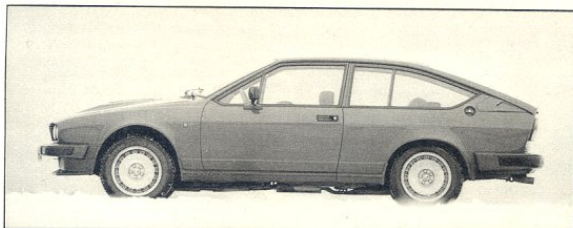
Erkennungszeichen des Sechszylinder-GTV: Hutze auf der Motorhaube und spezielle Alu-Räder
