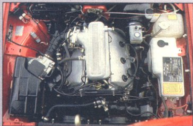
Prachtvolles Herzstück: V-Sechszylinder mit Benzineinspritzung
